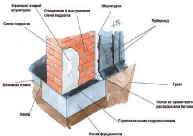
пенетрирующие материалы и использовать цемент марки М-100 или аналогичных марок. При высоком уровне грунтовых вод можно защитить оклеечную изоляцию со стороны почвы при помощи глиняного замка или прижимных стенок на основе кирпича.
